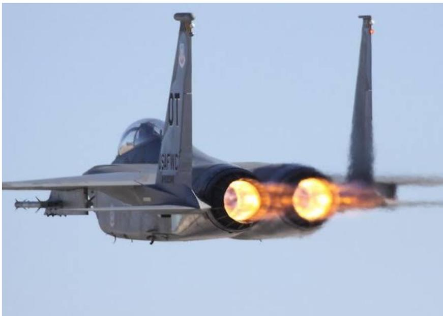
Figura 07. Motor a reação com pós-combustão, por isso a alta temperatura na saída. <https://www.aeroflap.com.br/alias-como-e-um-pos-combustor-internamente/>
