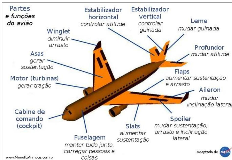
Figura 01: Desenho das partes principais de uma aeronave. Fonte: NASA
