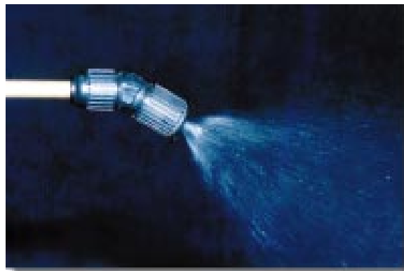
FIG. 21 - Jato de pulverização correto
